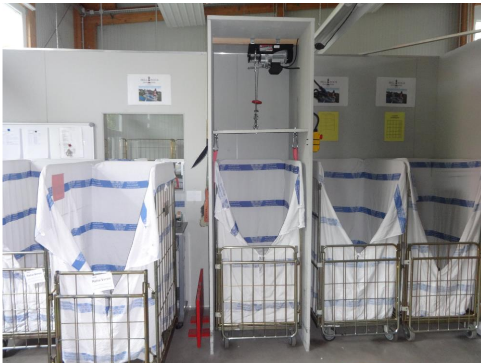
Hebemechanismus zum Beladen der Gitterboxen
